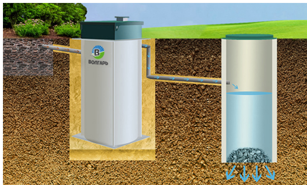
Отведение очищенной воды в фильтрующий колодец
